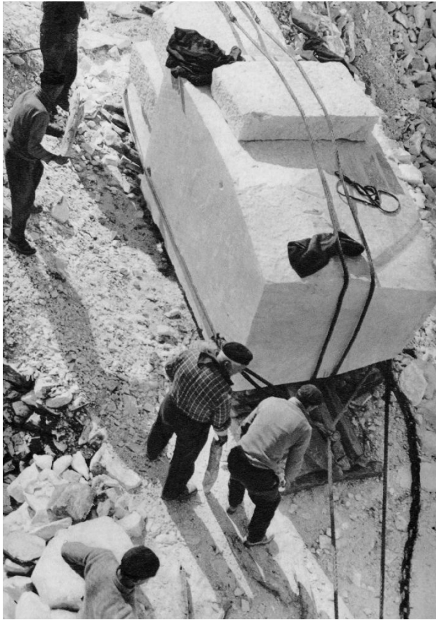
Abb. 2.46: Der Transport eines Marmorblocks mit dem System der lizzatura (Quelle: Klapisch-Zuber 1969, Abb. 22, Foto: Cav. Ilario Bessi).
